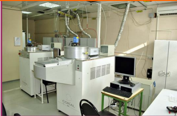
Установка плазмохимического травления и нанесения диэлектрика Corial
