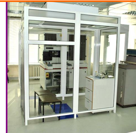
Установка обратного монтажа кристаллов Suss MicroTec FC150
