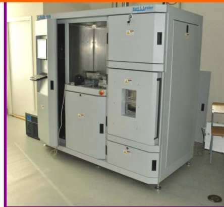
Установка напыления металла Kurt J. Lesker Lab-18
