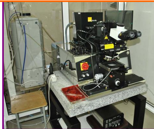
Установка экспонирования Suss MicroTec MJB-4
